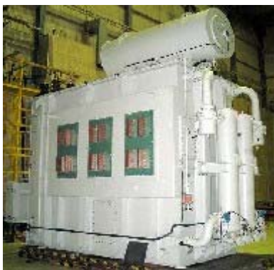
Figura 2. Transformador para hornos de corriente continua de 87 MVA, 12 impulsos
